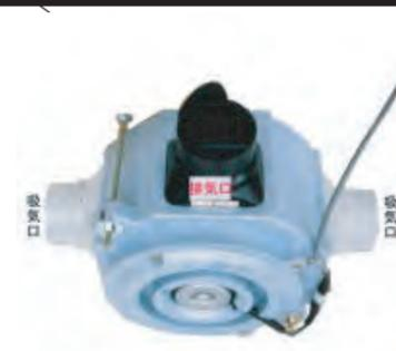
エアルーFRは排気型換気で天井裏(小屋裏)に本体を設置するので、全体に負圧がかかり室内の気圧をわずかに下げ、温度上昇を抑えます。換気方式は整流方式で、「置換換気」の方式を採用しています。この置換換気とは空気の温度による密度差を利用し、室温より数℃低い清浄空気を室内下部よりゆっくり供給し、室内で暖まった汚染空気を上に押し上げて、天井面から排出させる方式です。日本の高温多湿の風土に合い空気熱上昇も利用した排気型換気システムで、国土交通省での第3種換気システムです。
